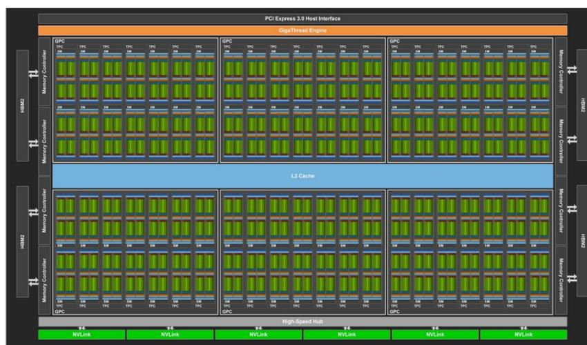
Figura 2.6: Arquitectura de Volta GV100.
