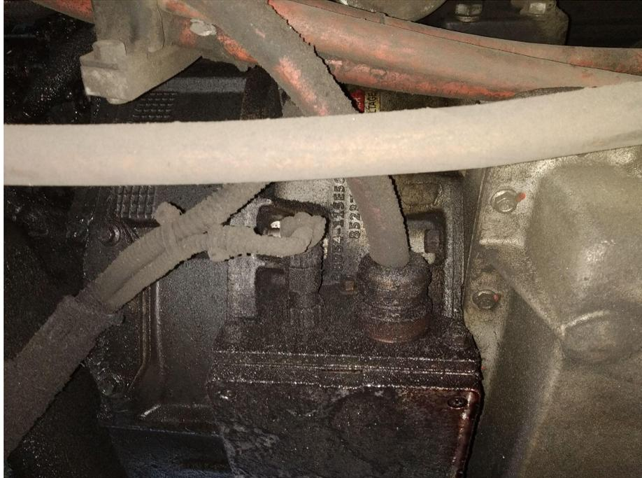
Ilustración 45: Fotografía de las conexiones del ISG.
