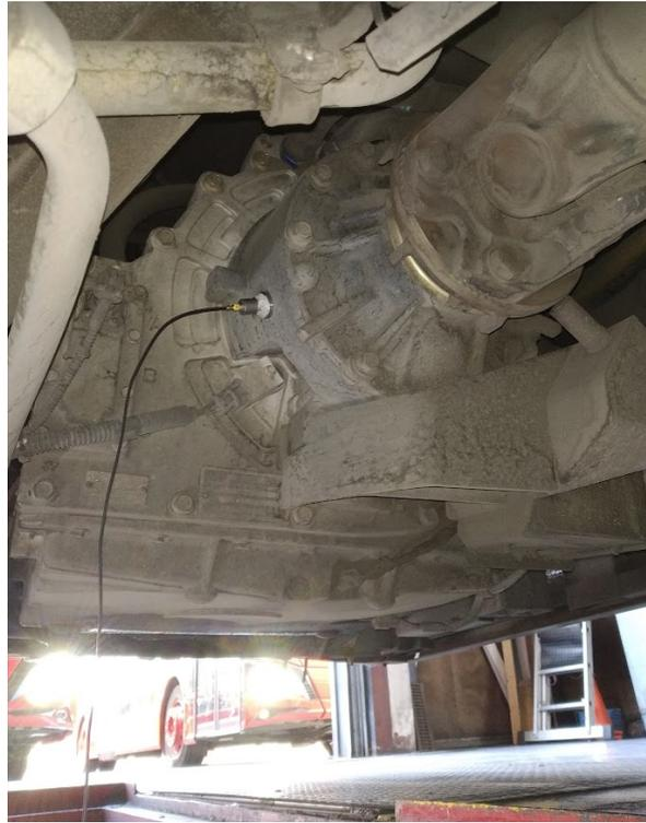
*Ilustración 34: Posicionamiento real del acelerómetro.*
