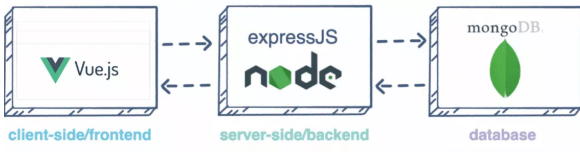
Figura 7.1: Esquema stack MEVN
