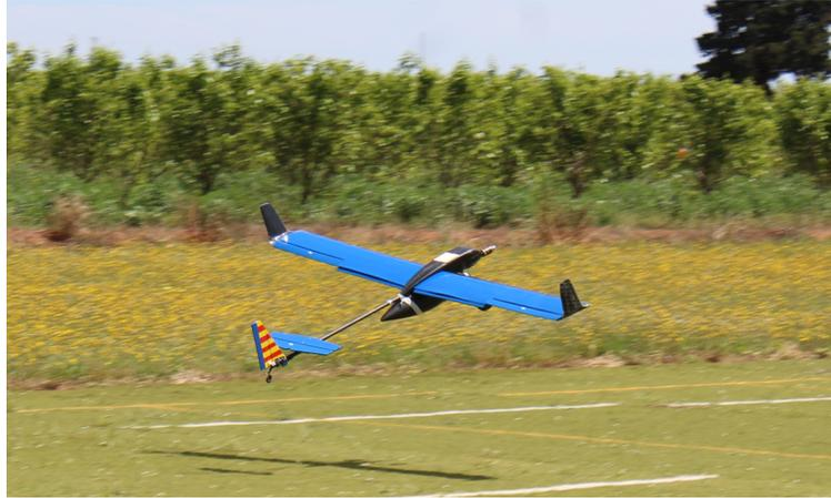
Figura 6.3: Prototipo durante el vuelo  $N^{\circ}6$  despegando a altos ángulos de ataque con el flap desplegado en posición intermedia.
