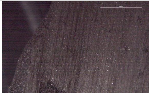
Fig. 52. Microfotografía de la superficie de la probeta antes de la consolidación (10X)
