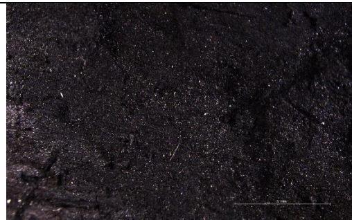
Fig. 31. Microfotografía de la superficie de la probeta después de la consolidación (10X)
