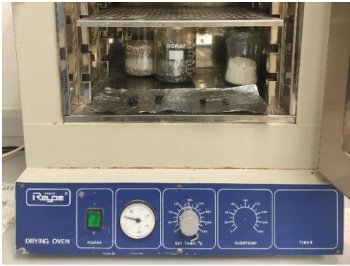
Fig. 26. Secado de las muestras en estufa de laboratorio
