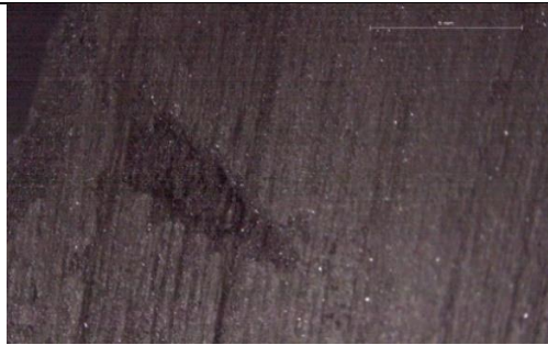
Fig. 46. Microfotografía de la superficie de la probeta antes de la consolidación (10X)
