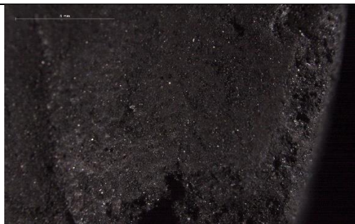
Fig. 48. Microfotografía de la superficie de la probeta antes de la consolidación (10X)
