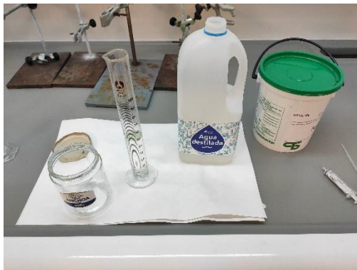
Fig. 11. Productos y materiales empleados para la preparación del consolidante Acril ME.
