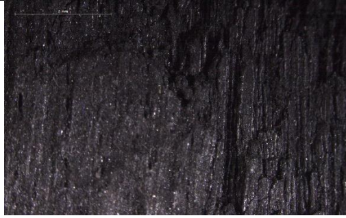
Fig. 50. Microfotografía de la superficie de la probeta antes de la consolidación (10X)
