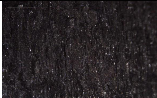
Fig. 34. Microfotografía de la superficie de la probeta antes de la consolidación (10X)
