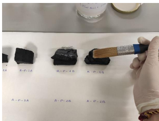
Fig. 12. Aplicación del consolidante sobre el fragmento mediante pincel
