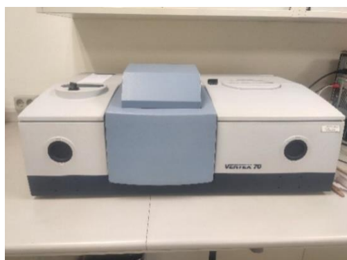
Figs. 27 y 28. Equipo de Espectroscopía ATR-FTIR Vertex 70 del laboratorio de análisis fisicoquímico del IRP, Universidad Politécnica de Valencia
