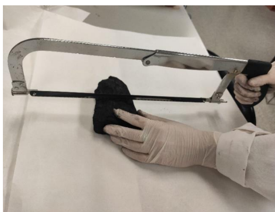
Fig. 7. Proceso de preparación de las muestras cortándolas mediante una sierra de mano.
