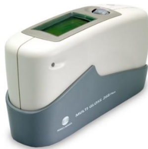
Figs. 18 y 19. Multi Gloss 268 A. Brillómetro Multi Gloss 268 Plus.
