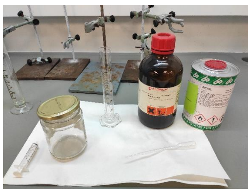
Fig. 10. Productos y materiales empleados para la preparación del consolidante Rexil.
