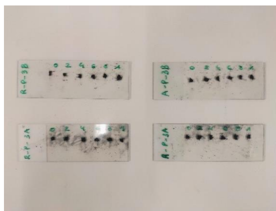
Fig. 29. Muestras extraídas de cada probeta de 0 a 1 cm de profundidad
