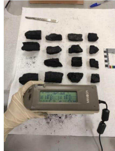
Fig. 20. Proceso de toma de datos mediante el Espectrofotómetro CM-2000d de KONICA MINOLTAR®
