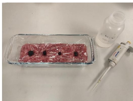
Fig. 25. Montaje para la realización del ensayo de absorción sobre los fragmentos de carbón arqueológicos
