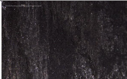
Fig. 40. Microfotografía de la superficie de la probeta antes de la consolidación (10X)
