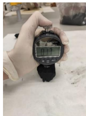
Fig. 22. Proceso de obtención de los valores de dureza de las probetas
