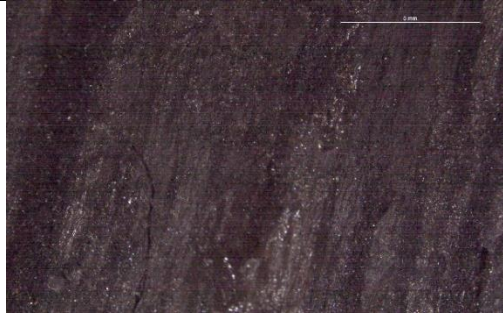
Fig. 38. Microfotografía de la superficie de la probeta antes de la consolidación (10X)
