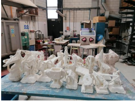
Figura 68. Moldes preparados para colocar en el lecho de colada. 2022.
