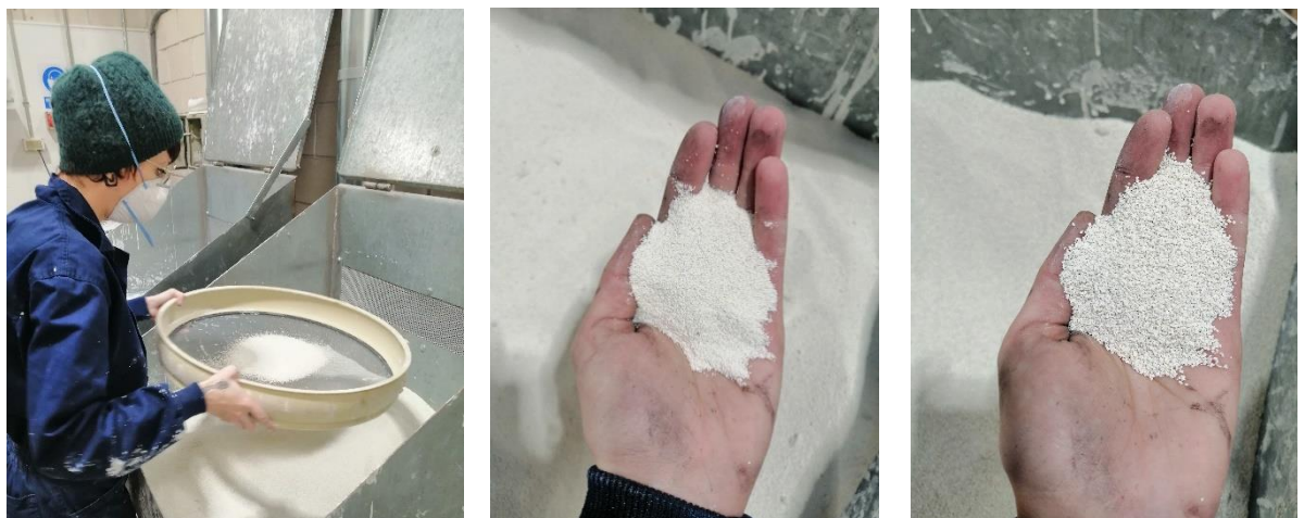
Figuras 62,63 y 64. Aplicación de áridos. Moloquita de grano fino y medio. 2022.
