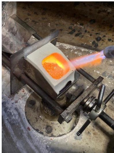
Figura 49. Latón en proceso de fusión en crisol. 2023.
