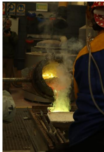
Figura 71. Vertido de latón en piezas. 2022.
