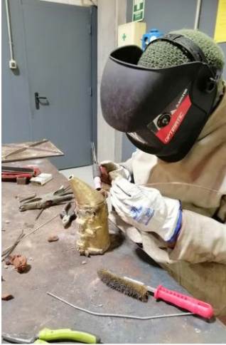
Figura 76. Paco P. Benavent realizando soldadura tipo TIG. 2023.
