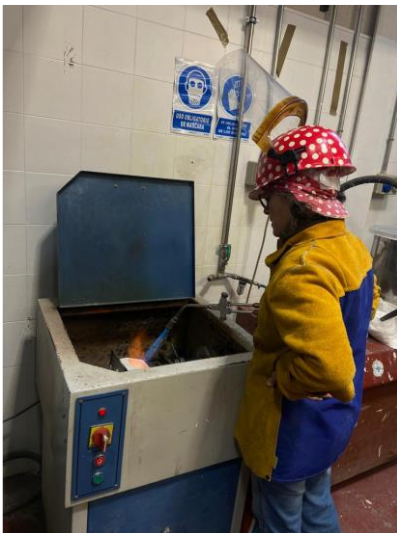
Figura 48. Carmen Marcos calentando el crisol con soplete. 2023.
