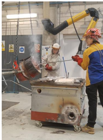
Figura 70. Carmen Marcos limpiando la superficie del metal fundido. 2022.
