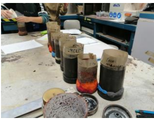
Figura 46. Cilindros preparados para vertido de revestimiento. 2023.
