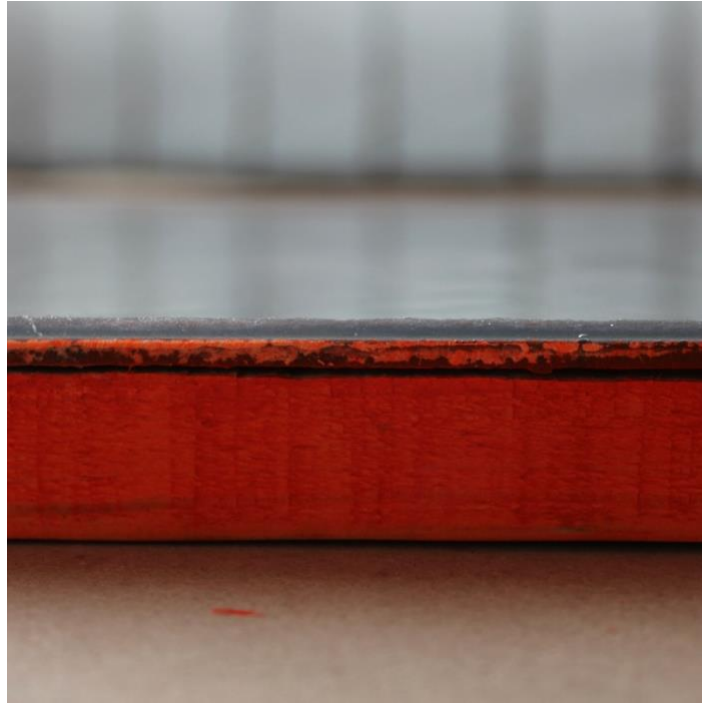
Figura A1. Detalle soporte con resina Epoxi.
