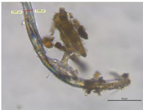
Fig. 44. Análisis longitudinal del grupo de fibras de lino, con un ligero giro en S, en el que se aprecian precipitado y restos desprendidos [Imagen digital]. ©Sofía Palomino, 2023.
