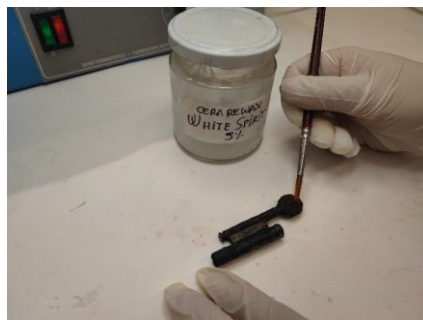
Fig. 64. Protección de los metales con la cera Reswax WH® [Fotografía]. ©Archivo fotográfico MPV, 2023.
