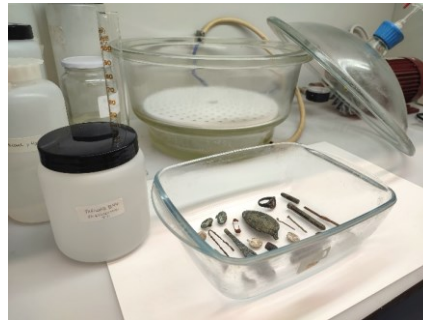
Fig. 63. Consolidación por inmersión en una campana de vacío [Fotografía]. ©Archivo fotográfico MPV, 2023.
