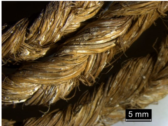
Fig. 28. Detalle de la saponificación y restos de tejido entre las fibras de esparto, ETN045 [Fotografía]. ©Archivo fotográfico MPV, 2022.
