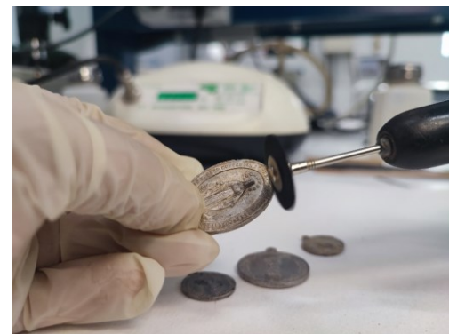
Fig. 53. Utilización del micromotor en una medalla metálica [Fotografía]. ©Archivo fotográfico MPV, 2023.
