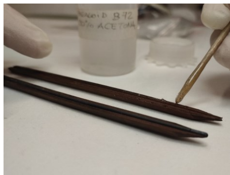
Fig. 57. Aplicación del adhesivo excogido en un lapicero [Fotografía]. ©Archivo fotográfico MPV, 2023.
