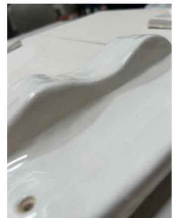
(Fig.67) Esmalte en suspensión por vertido
