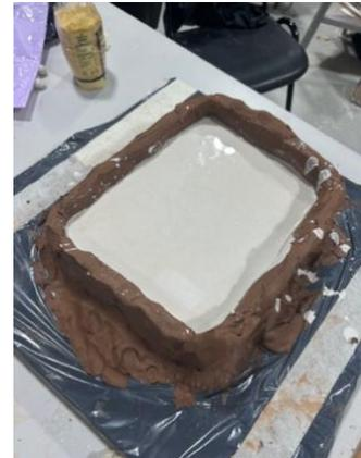
(Fig.57) Escayola fraguando para la reproducción de la pieza
