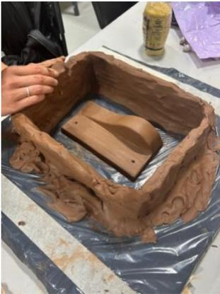
(Fig.55) Cama de arcilla para el molde
