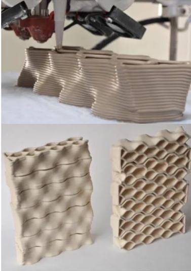
(Fig.38) Ladrillos de panal de Brian Peters mediante impresión 3D.
