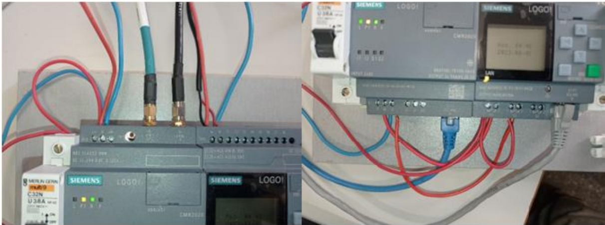
Ilustración 74 Detalle de la interconexión LOGO! CMR2020 y LOGO! BM 8
