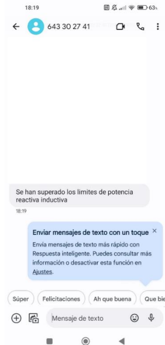
Ilustración 84 Aviso SMS por superar el consumo de potencia reactiva inductiva
