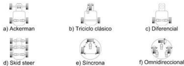
Figura 5. Configuraciones cinemáticas de los robots móviles con ruedas.
