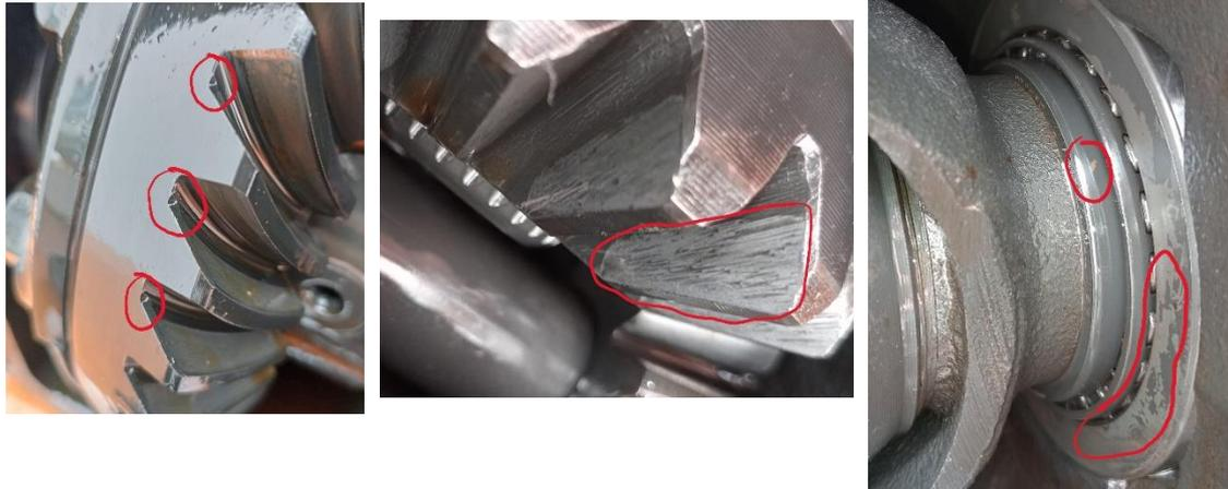
*Pruebas de desgaste. De izquierda a derecha: desgaste en corona, dientes de los satélites y planetarios, picado en parte interna de la carcasa. Fotografía propia*
