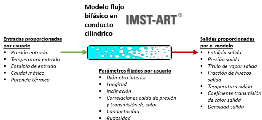
Figura 25. Esquema funcionamiento modelo análisis del flujo bifásico en conducto cilíndrico
