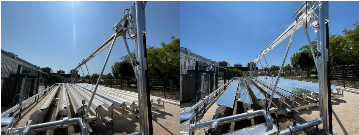
Figura 24. Planta experimental MicroGENVASOL con los espejos desorientados (izquierda) y orientados (derecha)
