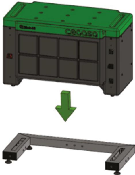
3. Apilar el resto de módulos eBick hasta un máximo de 4 niveles. Sin conectar en potencia ni comunicaciones
