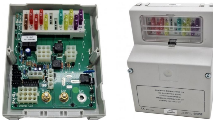
Imagen 20. Cajas fusibles y derivación 12 V
