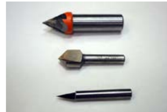
Fresa de talla en V, para grabados con detalle, generalmente utilizada para textos con bisel
