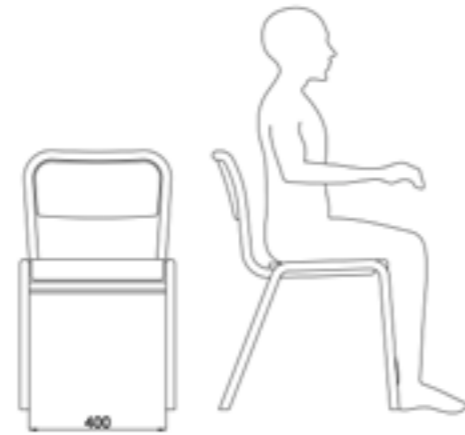
Fig. 12 Esquema ergonómico que muestra la anchura que debe tener el asiento de una silla para cplir con normativa. Elaboración propia
