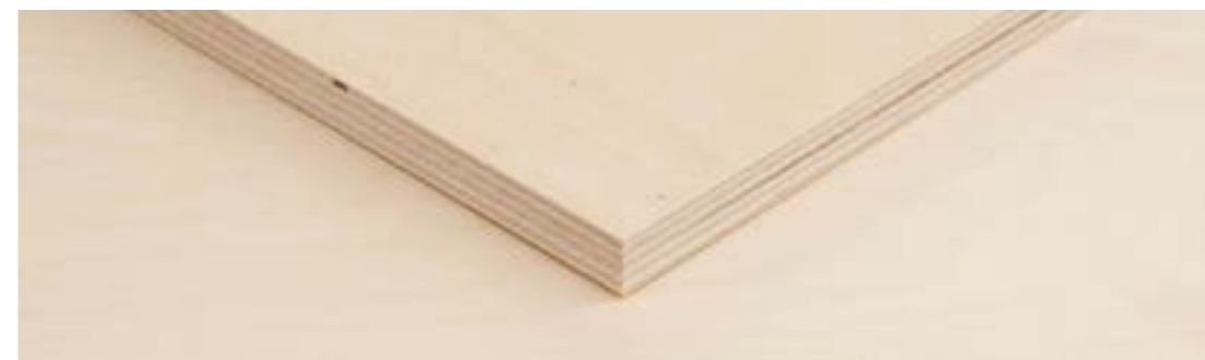
Fig. 27 Imagen de stock de una muestra de tablero contrachapado de abedul de 18mm de espesor
