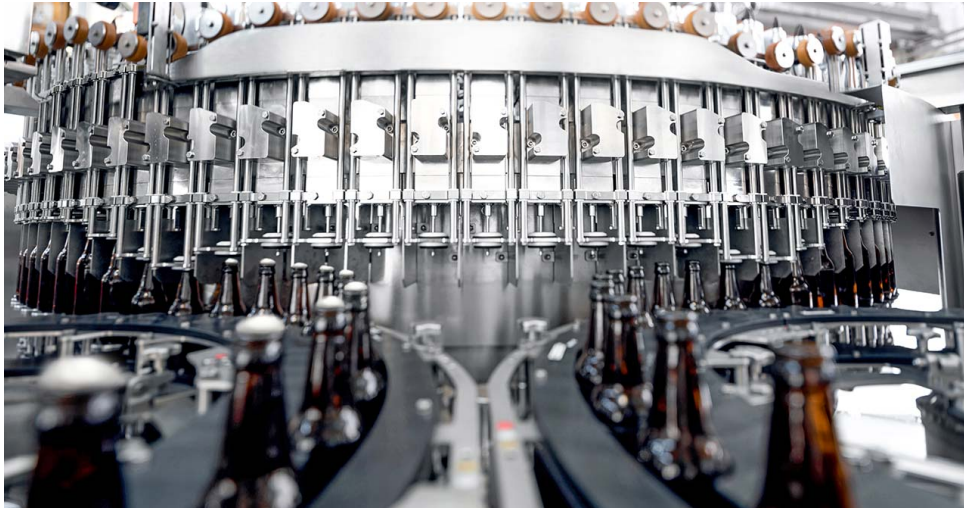
Figura 2.2: Máquina de llenado rotatoria
