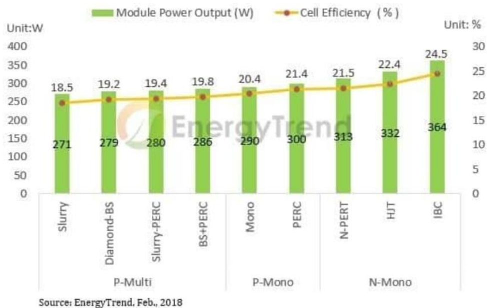
Figura 6. Potencia (W) y eficiencia (%) de módulos solares según la tecnología empleada – Fuente (EnergyTrend)
