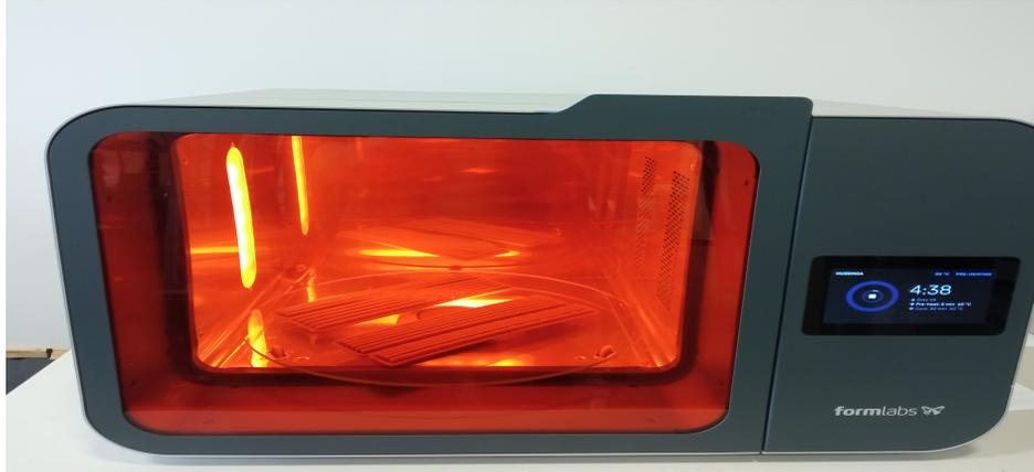
Figura 3.13: Proceso de curado de VGs mediante Form Cure L
