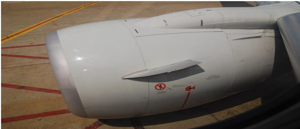
Figura 6.2: Nacelle Strike en un motor de un Boeing 737 [20]
