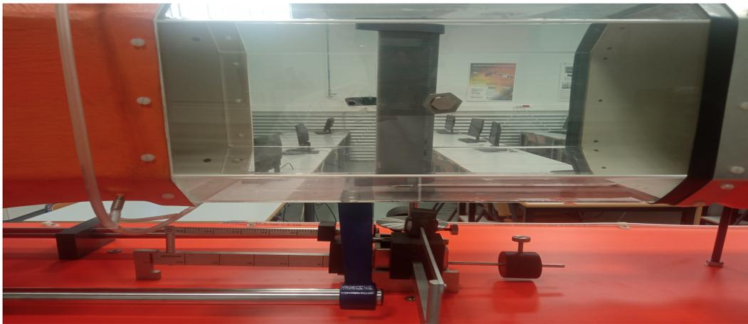
Figura 3.19: Detalle plato de balanzas con modelo montado
