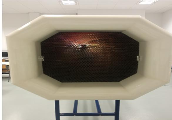
Figura 3.17: Detalle del panel de abeja en el túnel de viento subsónico
