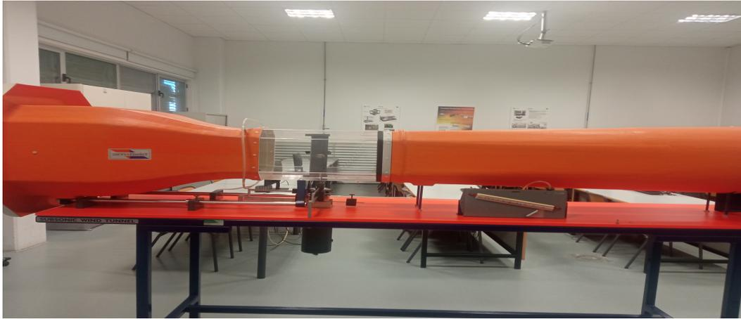
Figura 3.15: Túnel de viento subsónico en las instalaciones del CMT-Valencia
