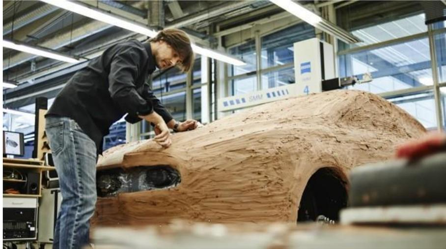
*Fig. 23. En la industria del automóvil son usuales los prototipos físicos hechos de arcilla.*
