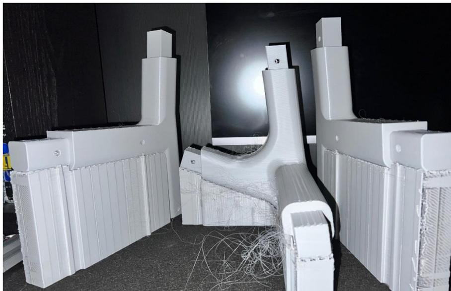
*Fig. 57. Algunas piezas del prototipo antes de remover los soportes.*
