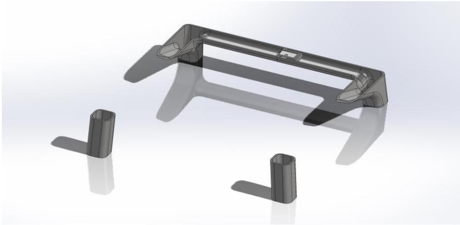
Fig. 47. Sección de las patas con el vaciado de espesor 4mm.
