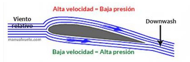
Ilustración 8: Principio de sustentación [Imagen] Fuente: manualdevuelo.com
