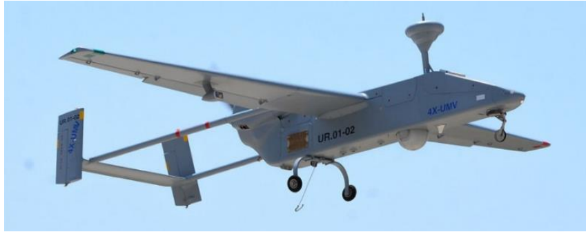
Figura 4.2: UAV modelo 4X-UMV para detección de incendios.
