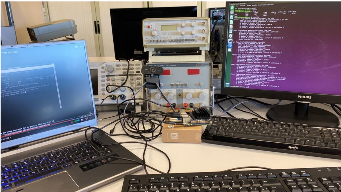
Figura 22: Montaje completo real de la tarjeta Nvidia Jetson Nano.
