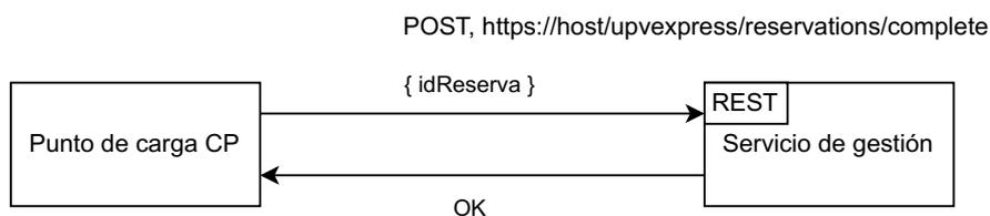
Figura 4.10: Completar reserva de un punto de carga mediante una petición REST
