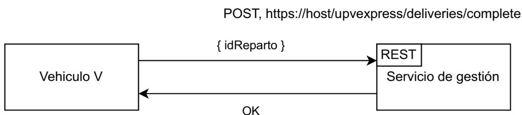
Figura 4.8: Confirmación de entrega de un reparto a través de una llamada REST
