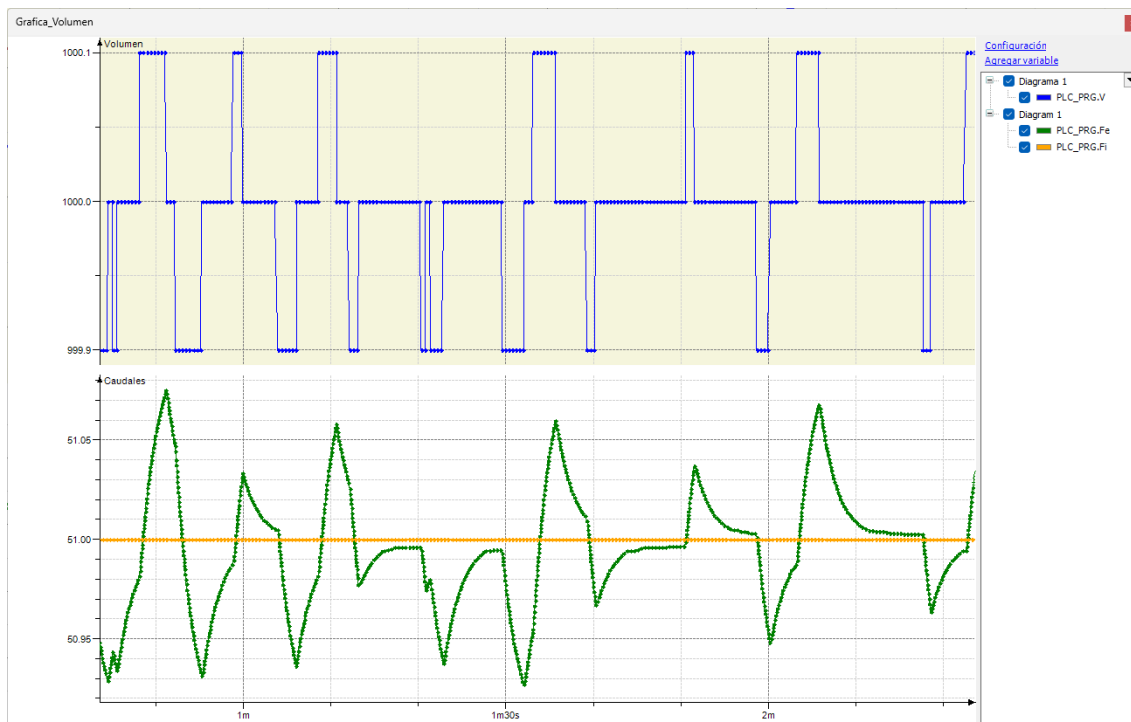
Figura 18. Gráfica control de volumen con perturbaciones en el entorno de CODESYS
