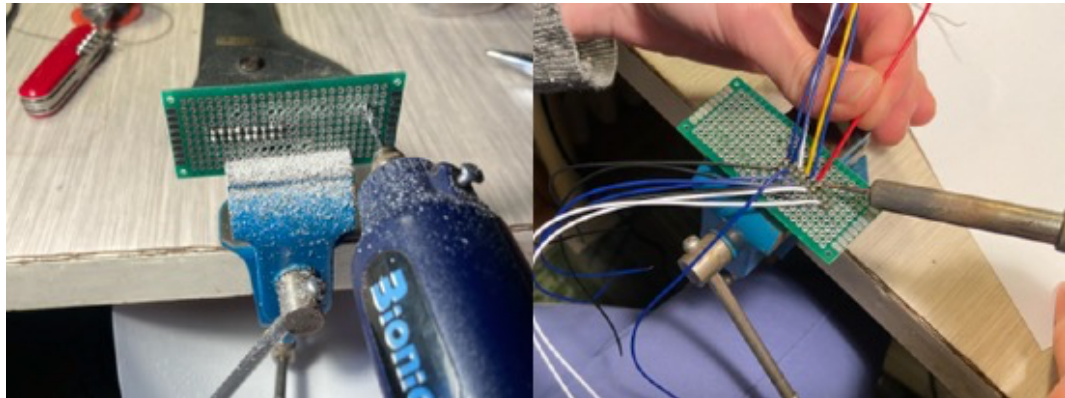
Ilustración 3.26. Para poder llevar los cables de conexión por las perforaciones de la placa, era necesario taladrar agujeros más grandes en la placa. (Este paso se podría saltar si se utilizan cables más estrechos.) En el siguiente paso se sueldan los cables a los pines correspondientes según el esquema de la ilustración 3.2 (parte derecha de la ilustración arriba).
