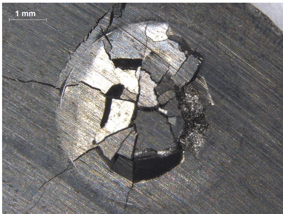
Figura 20: Fractura del Ti-10Fe tras el ensayo de Small punch.
