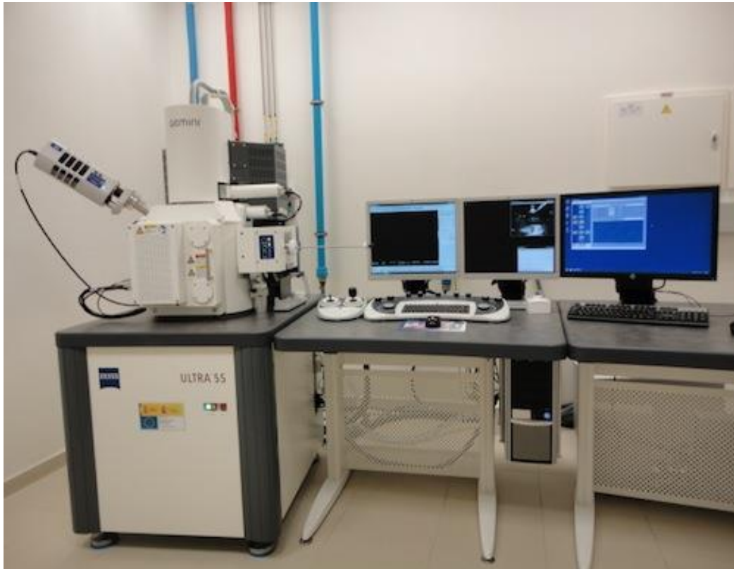
Figura 15: Microscopio electrónico de barrido modelo Ultra 55. (Universitat Politècnica de València)
