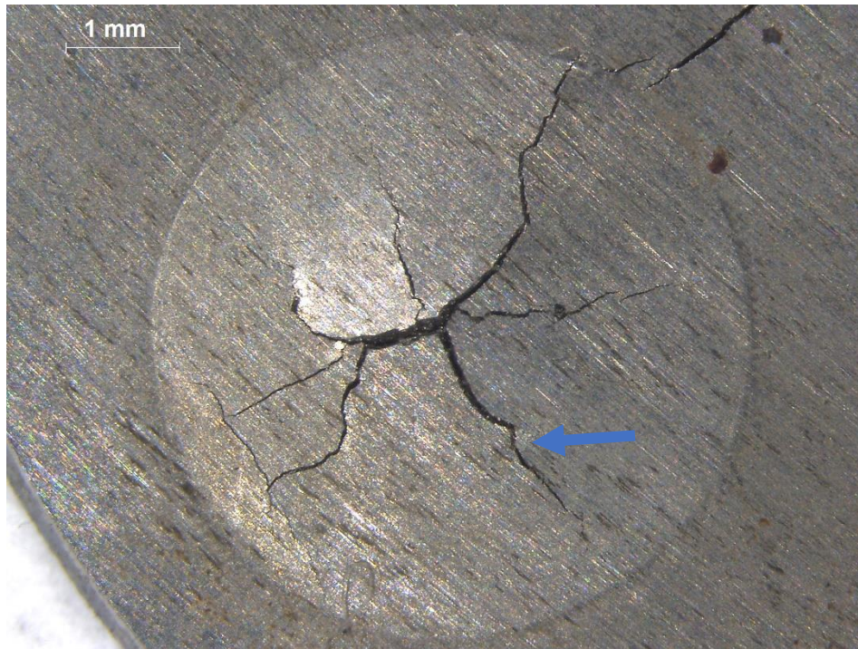
Figura 21: Fractura del Ti-5Fe tras el ensayo de Small punch.
