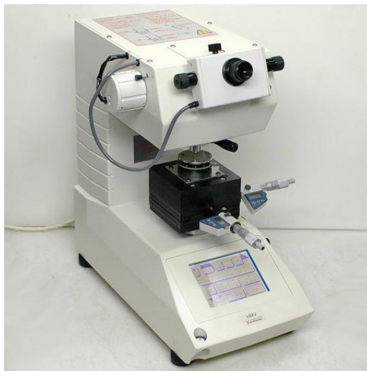
Figura 13: Durómetro HMV-2T usado para el ensayo de dureza Vickers. (Pinterest)
