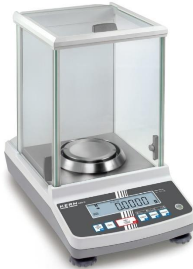
Figura 12: Balanza Kern usada para el cálculo de densidades. (Scales Measuring Instruments)
