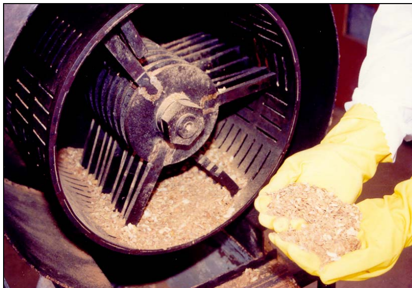
FIGURA 5. Molino trillador de martillos, Universidad de Piura, Perú
