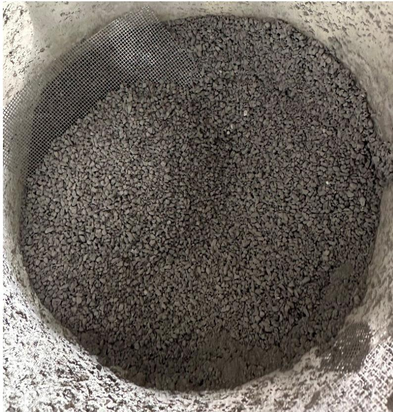
**Figura 10** : Fango de ETAP utilizado en los ensayos
