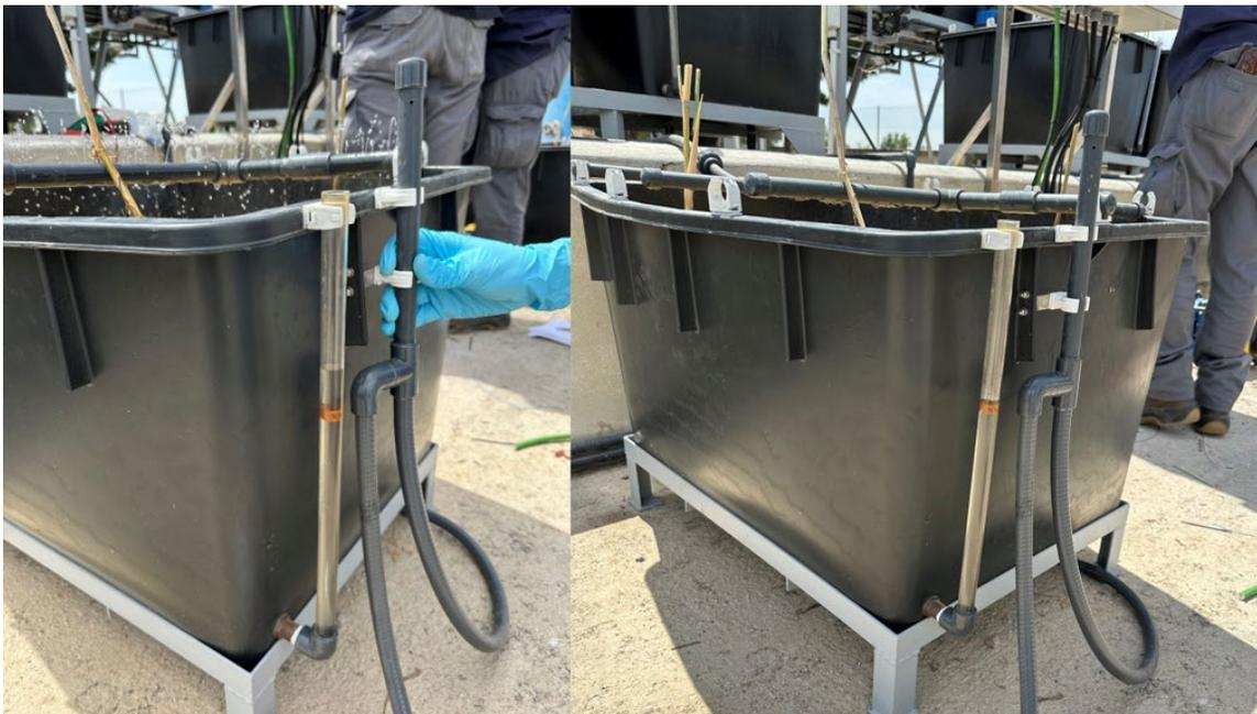
**Figura 21:** Tubo de salida de cota regulable en etapa 3
