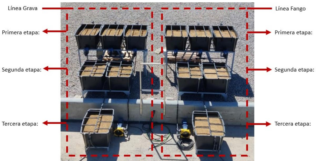
**Figura 12:** Planta piloto con línea de grava (izquierda) y línea de FDP (derecha) y tres etapas de tratamiento
