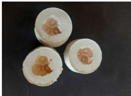
Fig. 18. Motles en bloc de silicona que vam utilitzar per al positiu en sèrie. 2023. Samuel Cases
