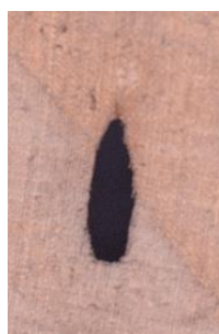
Figura 28. Macrofotografía de faltante a causa de la proximidad a la llama de un cirio.
