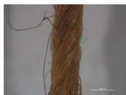
Figura 21. Fotografía realizada con LEICA KL200 LED, 6'5X de un hilo de la trama.
