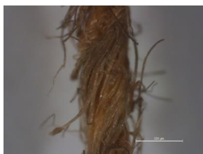
Figura 20. Fotografía realizada con LEICA KL200 LED, 6'5X de un hilo de urdimbre.
