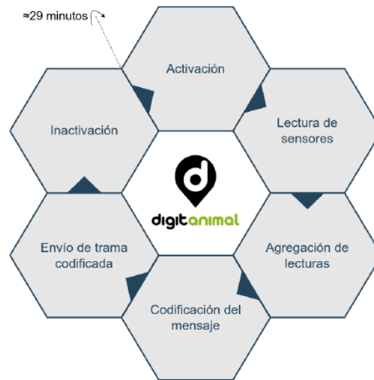
Figura 7: Ciclo de funcionamiento de equipos Digitanimal. Fuente: García (2022).
