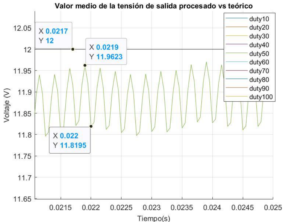
Figura 21. Ampliación de la tensión de salida tras el filtro EMA para el caso de 50% de duty.
