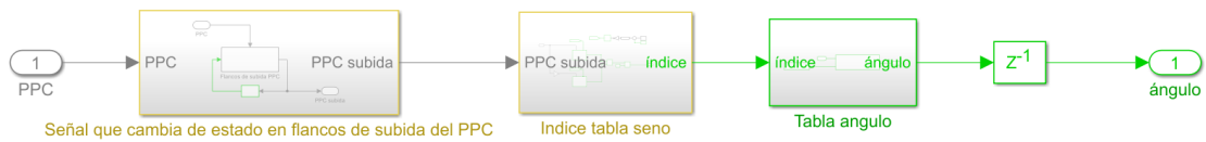
Figura 57. Subsistema “Generación ángulo a partir de PPC”.
