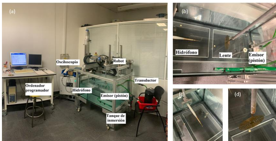
Figura 20. Configuración experimental donde se han realizado las pruebas desde un plano general (a) y desde dentro del tanque (b), donde se puede observar el hidrófono, la lente y el pistón. En (c) se muestra el hidrófono de aguja y en (d) la lente de Fresnel.
