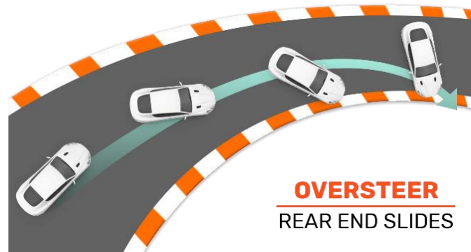
Figura 51 Ilustración de sobreviraje [46]
