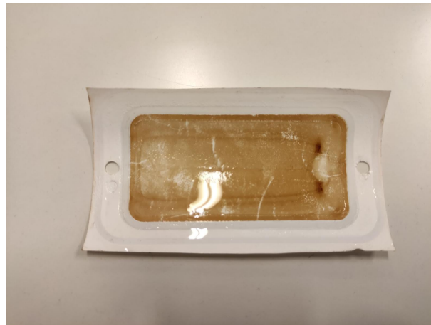
Figura 6.15: Efecto de ensuciamiento en la membrana polimérica NF270-2540 utilizada tras el paso de las vinazas.
