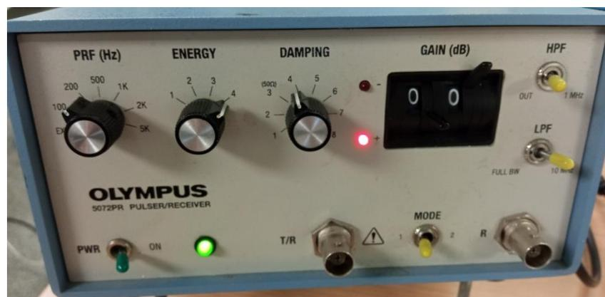
Figura 3.8 Parámetros de configuración del Pulser Olympus 5072.
