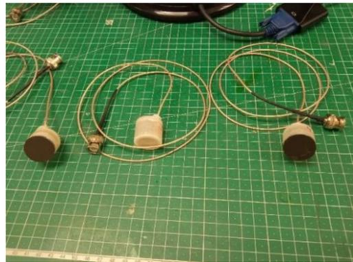
**Figura 3.2** Dos transductores con capa epoxi, y uno con capa 3D (central).
