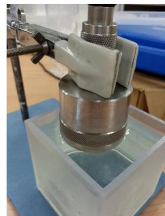
**Figura 3.4** Transductor comercial colocado en soporte.
