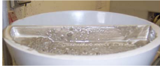
Figura 3.6 Material retenido en la rejilla del cono de Marsh
