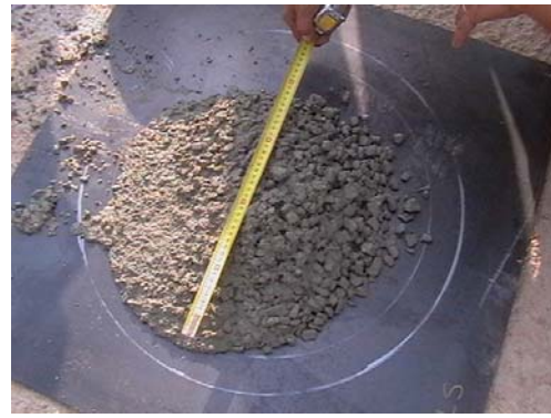
Fig 8.15. Esgurrimiento 400. Demasiado seco
