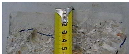
Fig. 3.21 Medida de la profundidad de segregación
