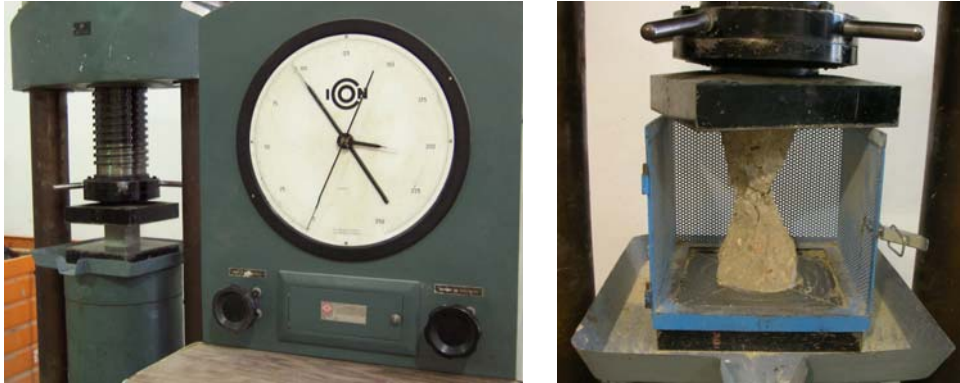
Fig 3.10 Prensa ICON. Capacidad de 250 toneladas
