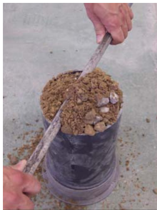
Fig. 3.24 Mezclas en seco. Enrazado de la probeta
