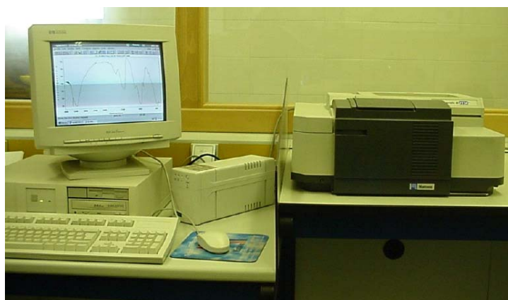
Fig. 5.1. Espectrometría Infrarroja FTIR
