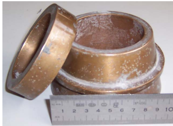
Fig. 3.30 Cono utilizado para realizar el ensayo de Flujo de cono reducido.
