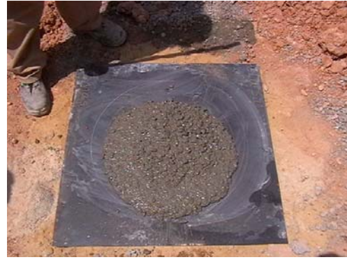
Fig 8.12 y 8.13. Esgurrimiento 550 mm – fluido y cohesivo
