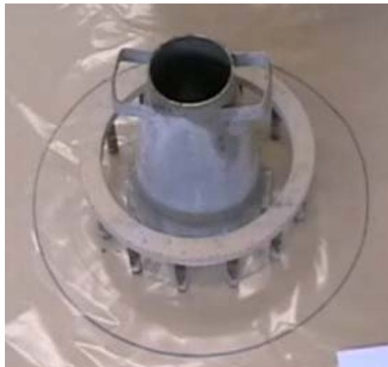
Fig 2.8 Ensayo de Ecurrimiento con anillo J
