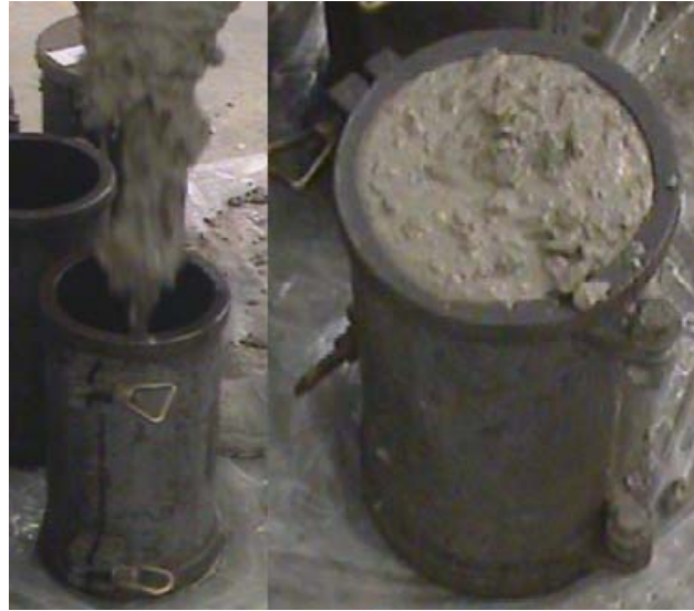
Fig 3.8 Llenado de probeta con HAC
