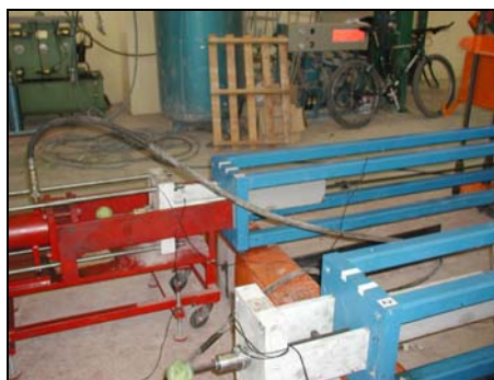
Fig. 3.49 Extremo de arrancamiento. Sistema hidráulico en posición.
