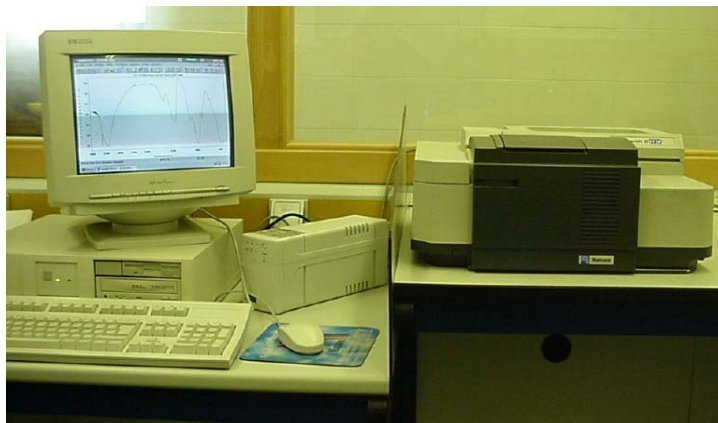
Fig.3.15. Equipo Mattson Genesis II F.T.I.R. para realización de espectrometría Infrarroja.
