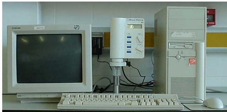
Fig.5.5 Viscosímetro rotacional Bohlin Visco 88 BV
