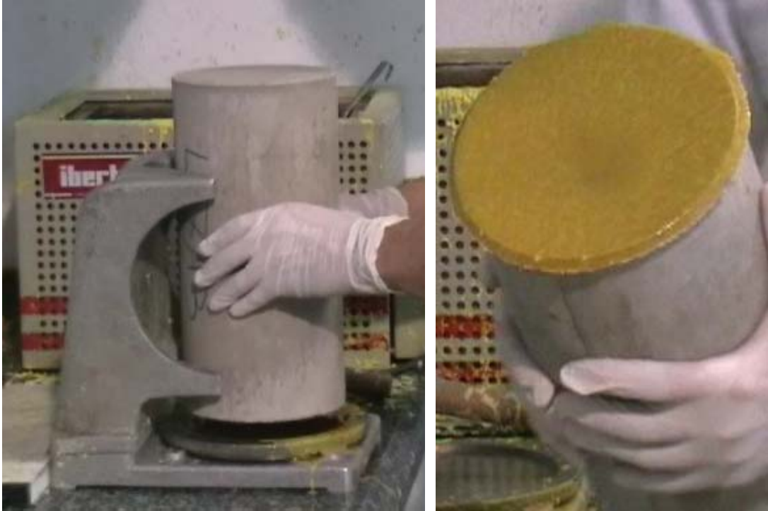
Fig. 3.9 Refrentado de probeta cilíndrica
