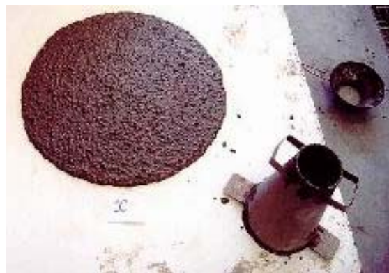
Fig 2.7 Dimensiones del Cono de Abrams y realización del ensayo
