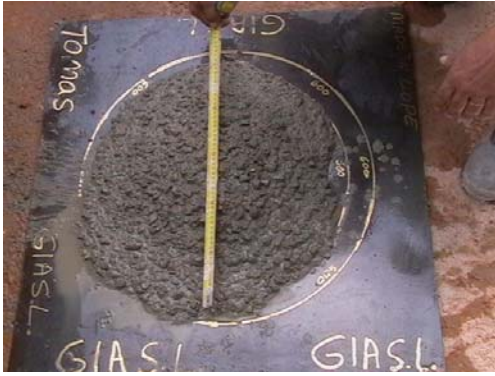
Fig 8.12 y 8.13. Esgurrimiento 550 mm – fluido y cohesivo
