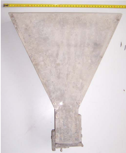
Fig. 3.31 Embudo en V reducido
