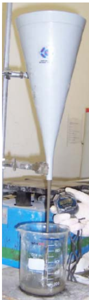
Fig 3.5 Ensayo y dimensiones del cono de Marsh
