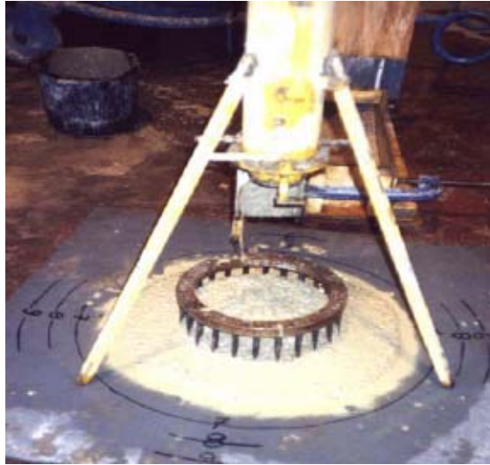
Fig 2.9 Ensayo Orimet con anillo J
