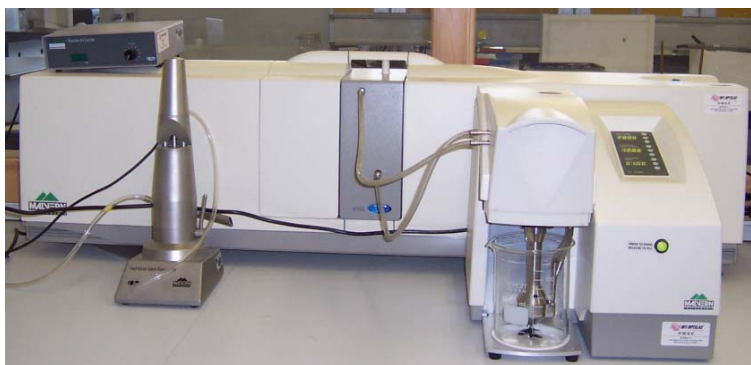
Fig. 3.14 ADL – Equipo para el análisis de tamaño de partícula por difracción de rayos Láser
