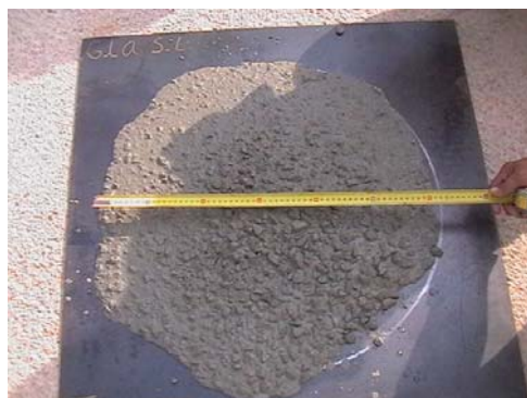
Fig 8.11. Ecurrimiento 620 – Segregado / sin cohesión
