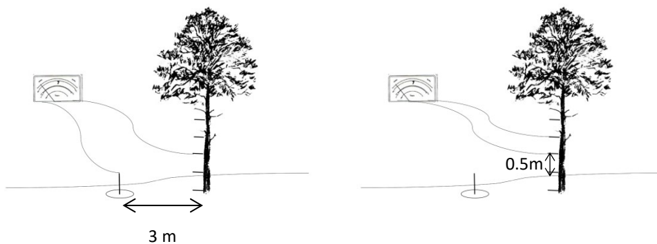
Figura 8. Modos de colocación de los electrodos (izquierda) mediciones referenciadas a tierra, (derecha) configuración bipolar.
