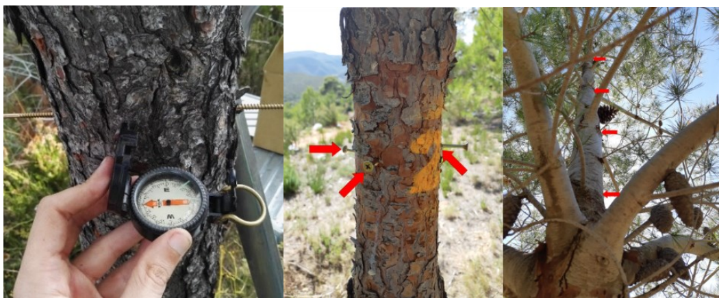
Figura 7. Colocación de los electrodos mediante brújula (izquierda), identificación de los árboles y ubicación radial de los electrodos (centro), electrodos separados longitudinalmente (derecha).
