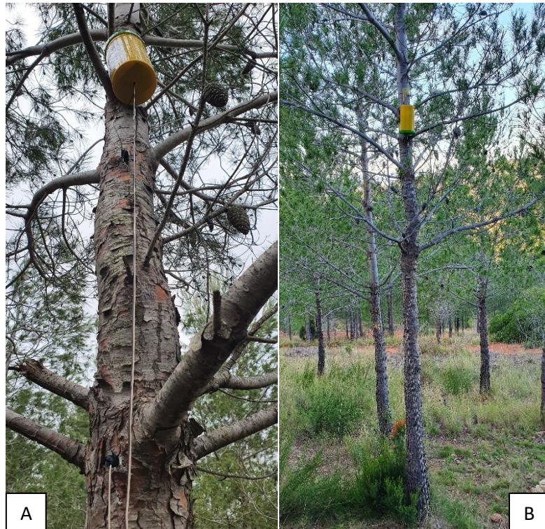
Figura 16. Emplazamiento de adquisición de datos a corto plazo en un árbol seleccionado. Visión cercana de la cápsula estanca (A). Visión general de la instalación (B).
