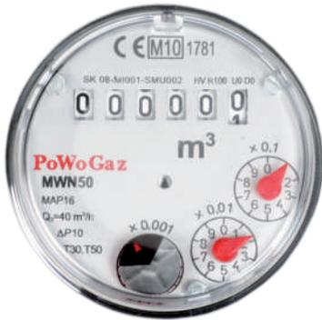
Totalizador de agujas y tambores, acondicionado al montaje del emisor vía radio, coopera con los emisores NK y NO. El totalizador está equipado con un elemento de transmisión óptica de datos, colocado en la protección hermética, hecha de plástico.
