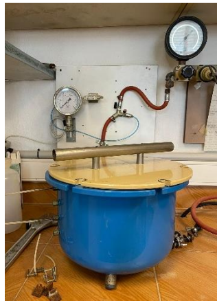
Figura 5 Olla de Richard de baja presión para 0.33 atm.
