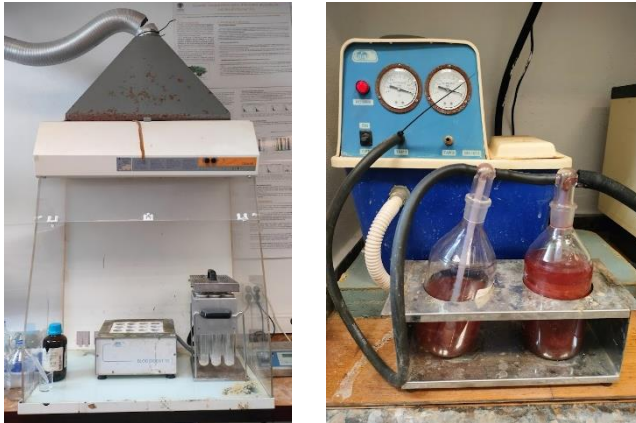
Figura 4 En Fase de digestión se encuentra la campana de extracción junto con el digestor; En la fase de destilación, el destilador usado también en la ureasa y en la Capacidad de Intercambio Catiónico
