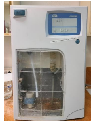
Figura 4 En Fase de digestión se encuentra la campana de extracción junto con el digestor; En la fase de destilación, el destilador usado también en la ureasa y en la Capacidad de Intercambio Catiónico
