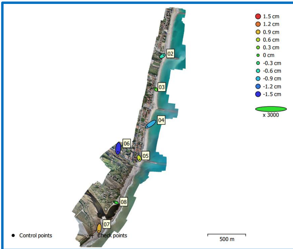
Ilustración 7: Puntos de control y elipses de error planimétricas, el error altimétrico está representado por color – Fuente: Elaboración propia.
