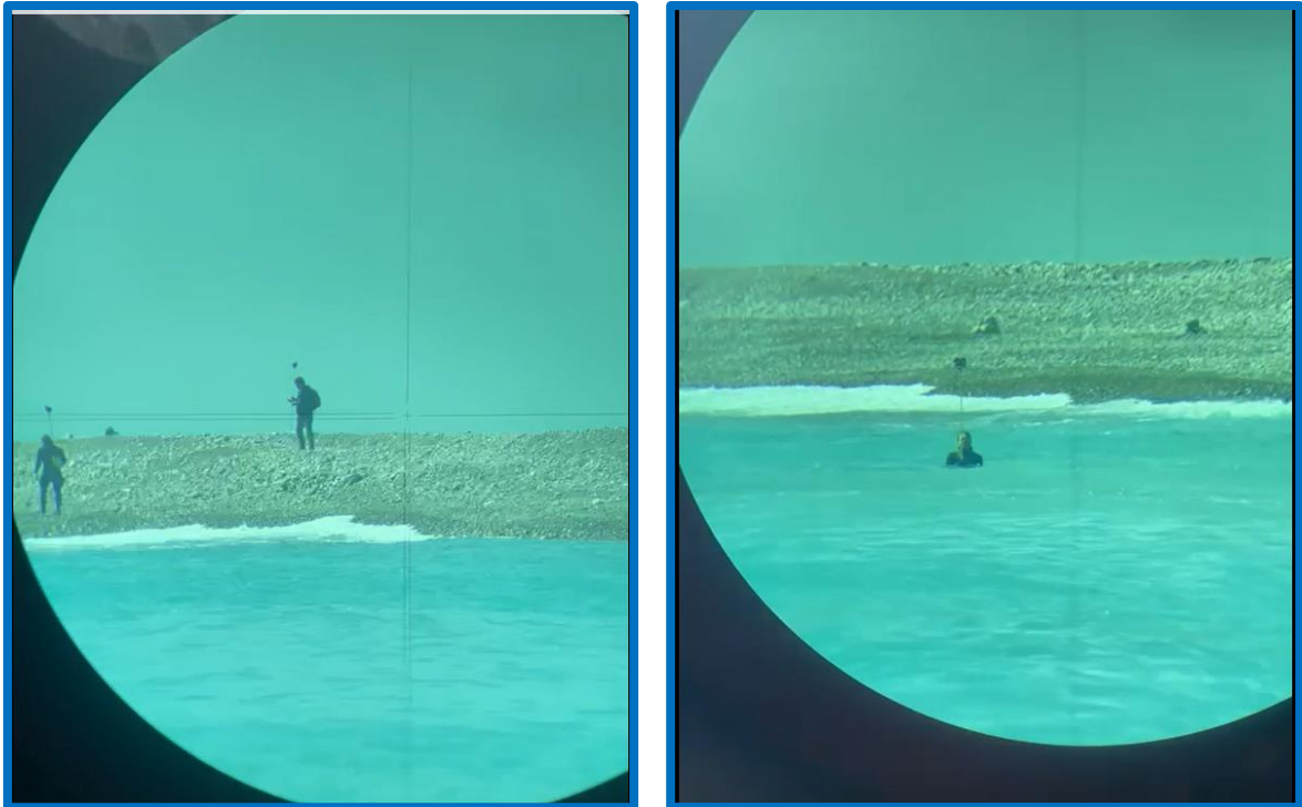
Ilustración 21: Topógrafo indicando al operario donde sumergirse siguiendo la planificación- Fuente: Elaboración propia.
