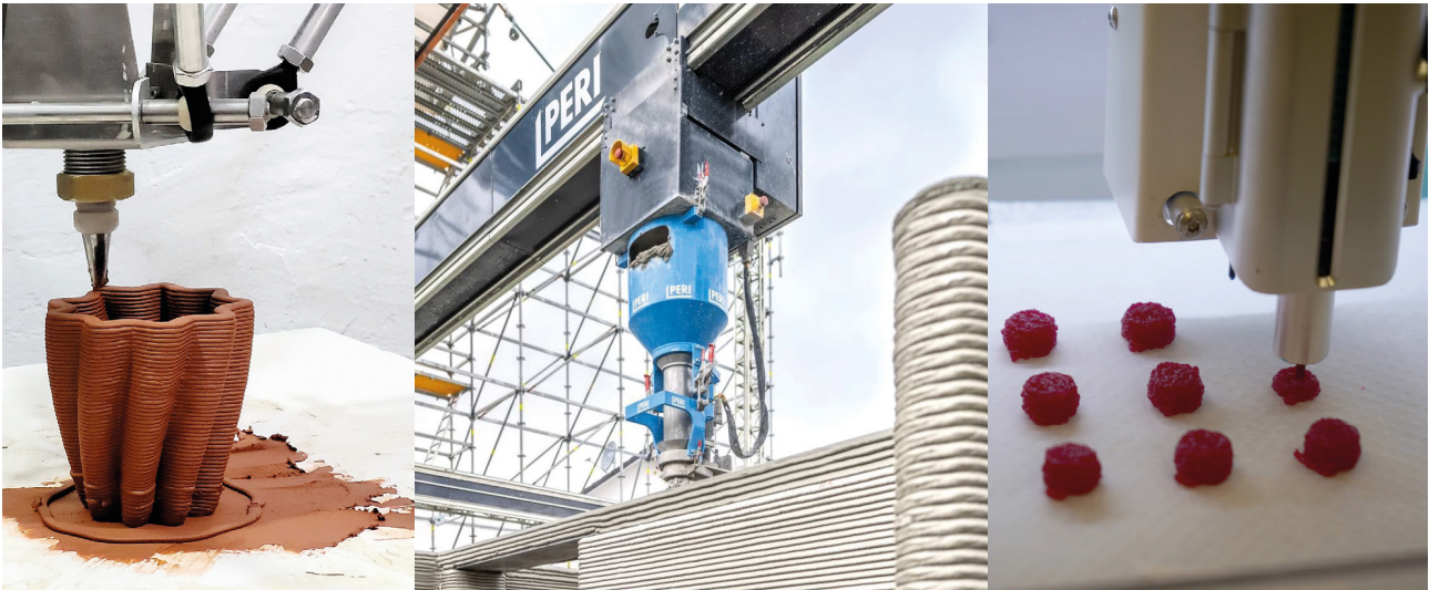
Figura 1. De izquierda a derecha: impresión 3D de cerámica (Universidad Nebrija) 3 , hormigón (empresa PERI Group) 4 y de fármacos (hospital Vall d'Hebron) 5
