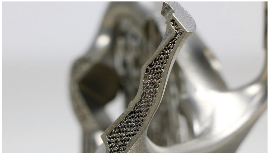
Figura 24. Estructura lattice aplicado en el interior de una pieza
