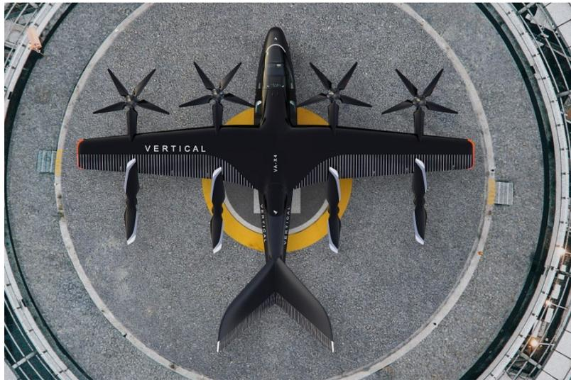
*Ilustración 1.4: Modelo de eVTOL VX4 de la empresa Vertical Aerospace*
