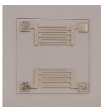
Figura 60. Diseño con dos electrodos y espacio para las muestras.
