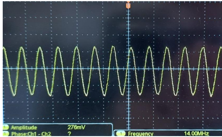
Figura 27. Señal recibida por el osciloscopio a través del sensor ( f = 14 MHz).
