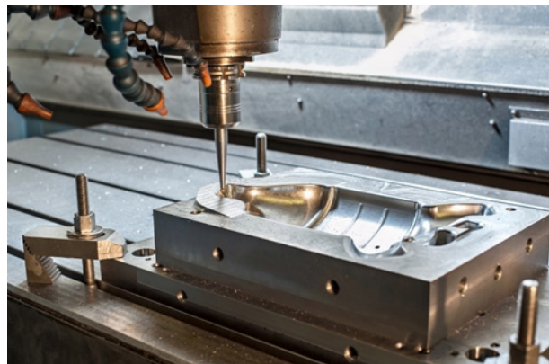
Figura 2. Fabricación de molde (Mountain Spring Products, 2015)
