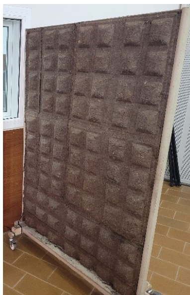
Figura 12. Foto pantalla de aislamiento
