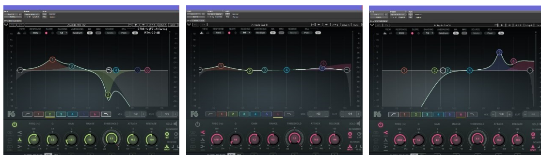
Figura 30. Ecuilización de las pistas de contrabajo. por orden AKG D112, línea y Shure SM57
