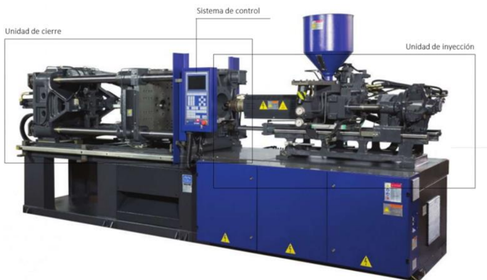
Ilustración 126. HAITIAN MARS II Series. Unidades de la máquina. [Imagen] Fuente: Elaboración propia en base a http://haitianpm.com/
