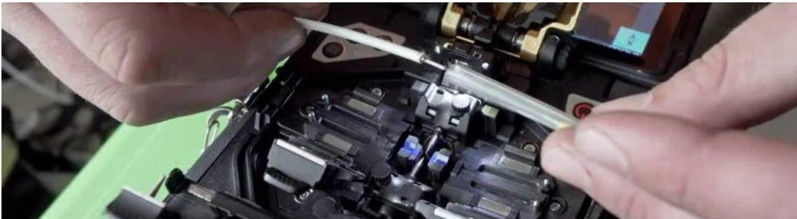
*Ilustración 5: Técnico de fusión de fibra realizando una conexión*
