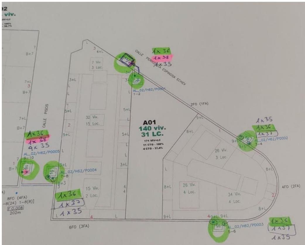
Ilustración 54: Plano de representación del albarán de cajas tras su instalación
