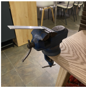
Figura 10. Doblado de metal con tornillo de banco.
