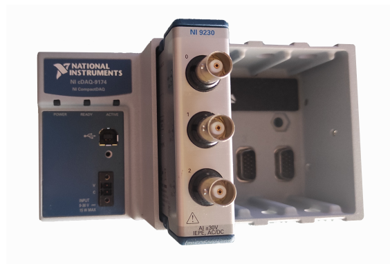
Figura 3.4: Sistema de adquisición DAQ NI 9230 instalado en el chasis NI CompactDAQ cDAQ-9174
