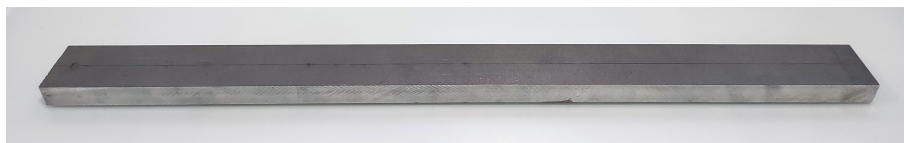
Figura 5.1: Barra de aleación de aluminio 7075-T6
