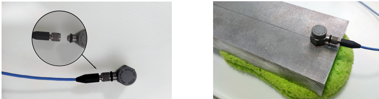
(a) Conexión del acelerómetro
