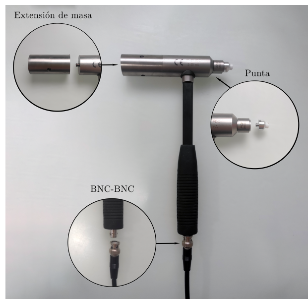
Figura A.3: Montaje del martillo instrumentado
